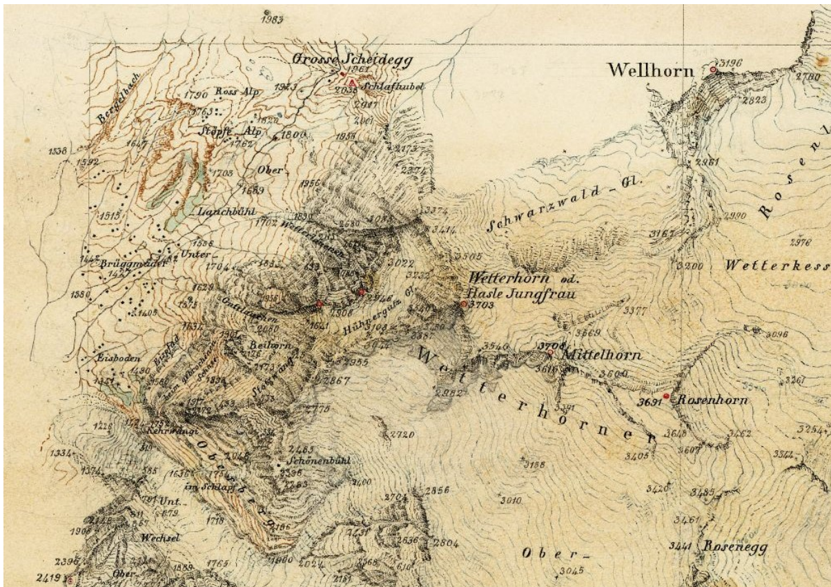
Abb. 26: Ausschnitt aus dem auf Holz aufgezogenen Messtischblatt (unpublizierte Originalaufnahme) Berglistock 1:50 000 des Topographen Jules Anselmier von 1861. (swisstopo, Kartensammlung, LT OA BE 40. www.alexandria.ch > Suche nach «bv080209760»).
