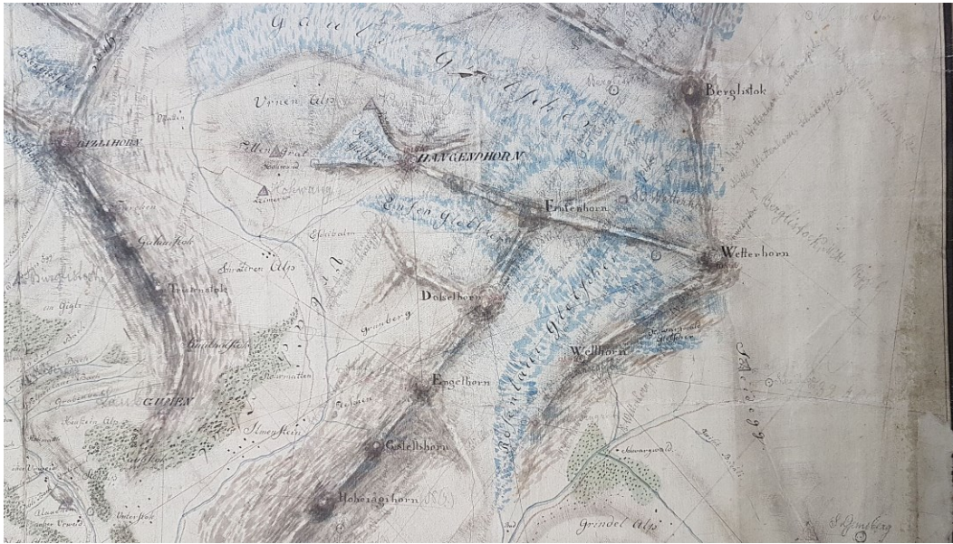
Abb. 17: Ausschnitt Wetterhorn aus der Trigonometrischen Aufnahme des Amts-Bezirks Ober-Hasli von Ingenieur-Lieut. Frey von Knonau 1815 . Die in Tusche ausgezogenen Visuren stammen aus der berechneten Triangulation ( Abb. 16 ), welche durch zahlreiche Visuren samt Beschriftung in Bleistift ergänzt wurden, sodass hier zumindest in Teilen auch rein graphisch trianguliert wurde. Beim Wetterhorn ist in roten Zahlen die Höhe «10466» beigefügt. (StABE; AA IV Oberhasli 3).
