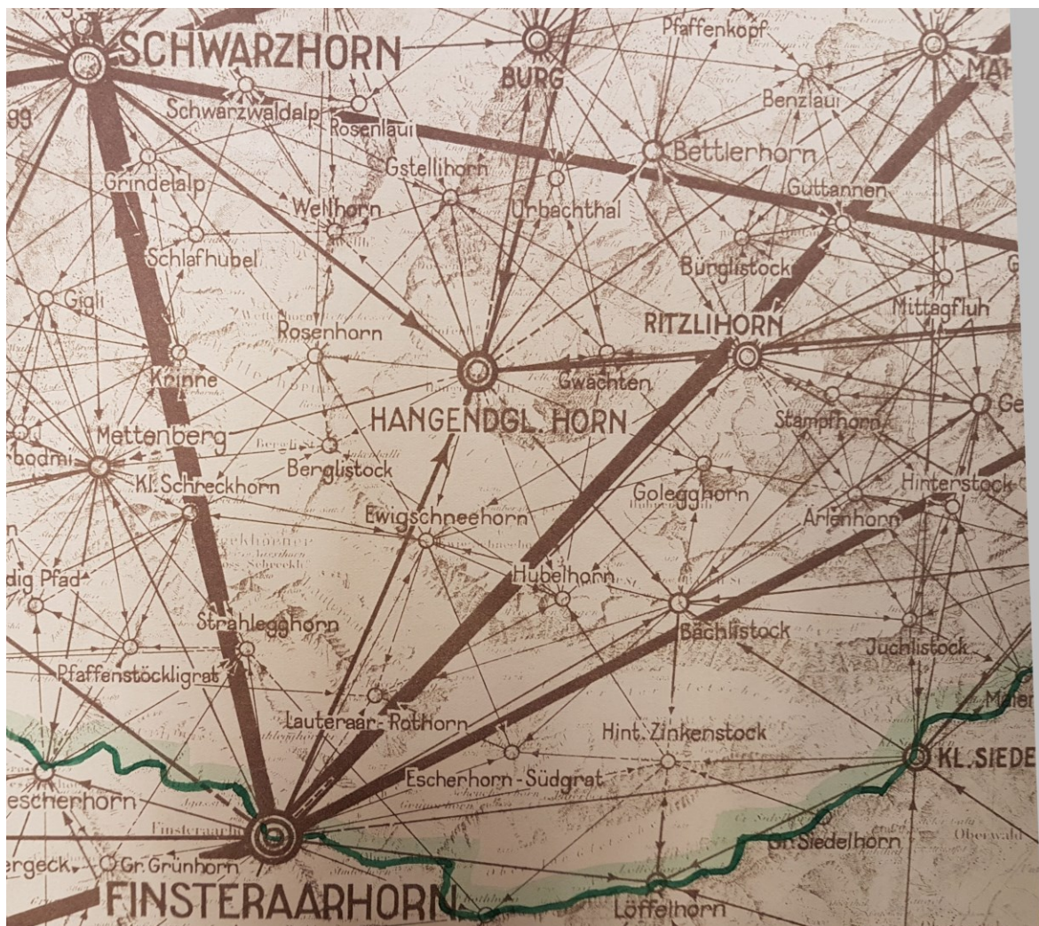
Abb. 29: Ausschnitt aus dem Netzplan der Triangulation I.–III. Ordnung des Kantons Bern. D (StABE, AA I 84).
