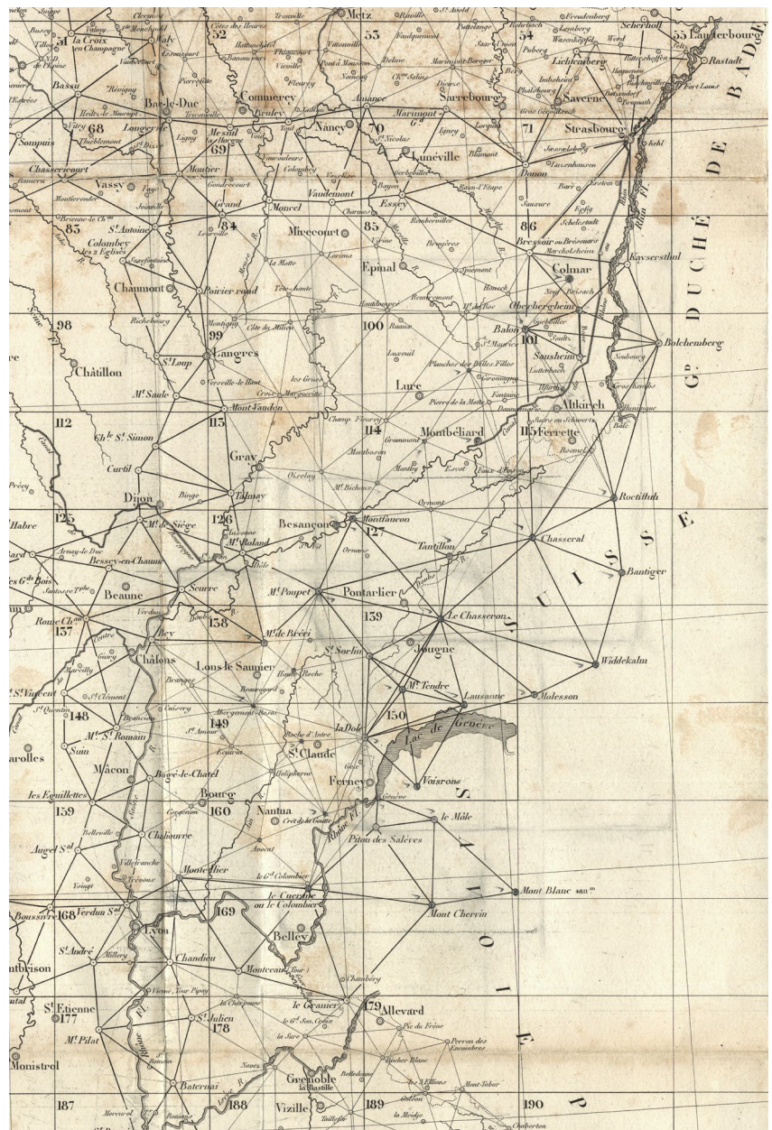
Fig. 21: Extrait du plan du réseau de la Carte générale des triangles fondamentaux et des principaux points secondaires de la nouvelle carte topographique de la France gravée à l'échelle de 1 pour 80,000 comprenant le tableau d'assemblage des feuilles de cette carte. Dressée par ordre du Ministre de la guerre, sous la direction de M. le L. G. al Pelet, pair de France, Directeur du Dépôt de la Guerre. Cette carte était jointe à la Nouvelle description géométrique de la France, publiée par Puissant en 1832 (Puissant [1832], pièce jointe). Extrait réduit à 60%.
