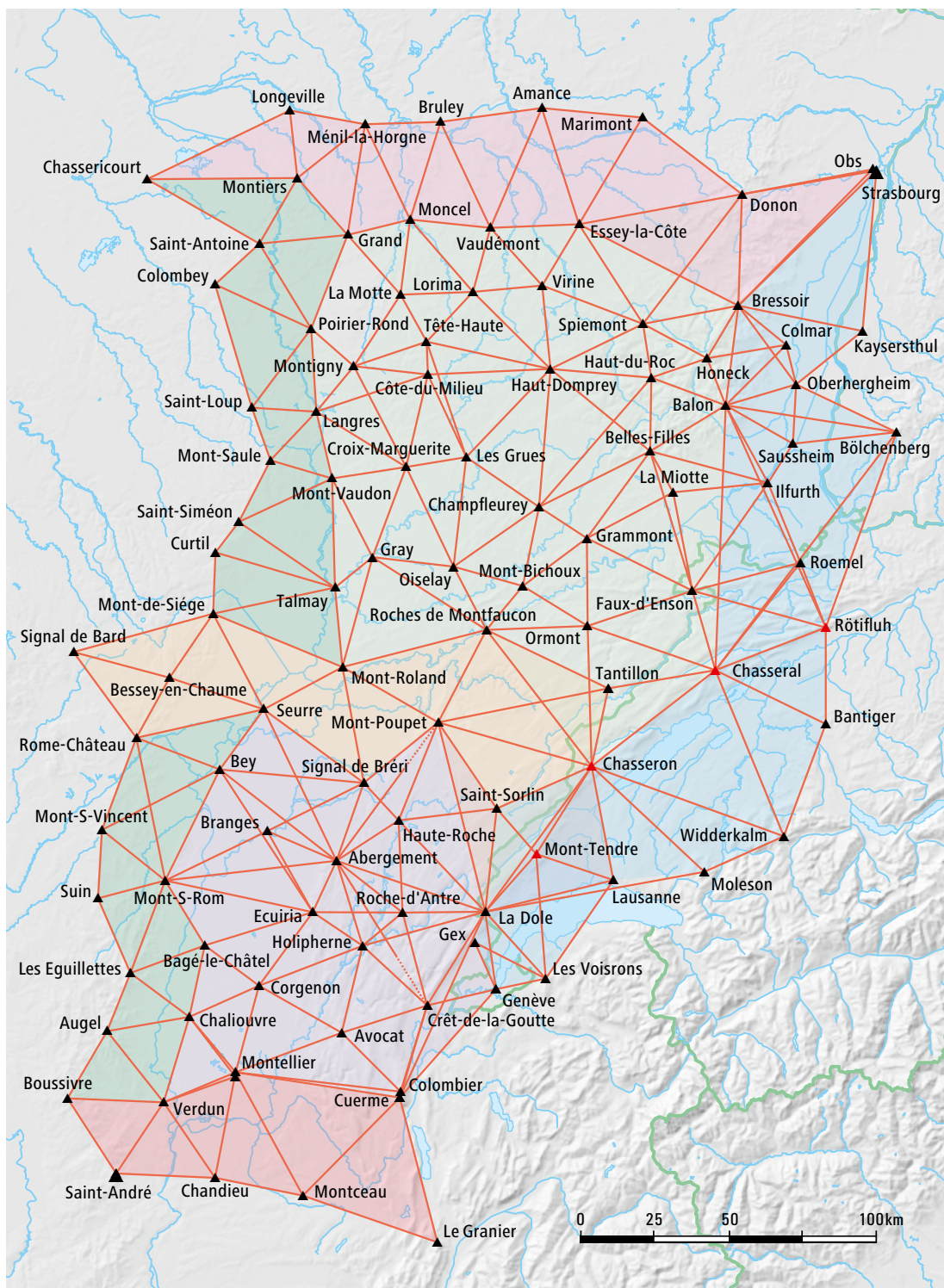
Fig. 23: Plan du sous-réseau Est français issu de la Nouvelle description géométrique de la France (cf. fig. 20), saisi pour les besoins de cette étude. Des couleurs différentes ont servi pour les sept sous-réseaux utilisés. Positionnement minimal du réseau sur les deux points Strasbourg et Saint-André (grands triangles noirs). Un centre séparé a été introduit pour les mesures les plus anciennes (méridienne de Strasbourg) concernant les points de la partie suisse de la crête principale du Jura (triangles rouges sur le plan) (graphique: Patrick Flückiger, swisstopo).
