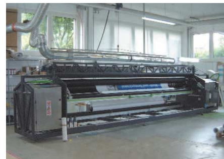
Abb. 11: Mit diesem Plotter wurde das DIGIRAMA durch die Firma Stutz Foto Color Technik AG auf Stoff übertragen.
